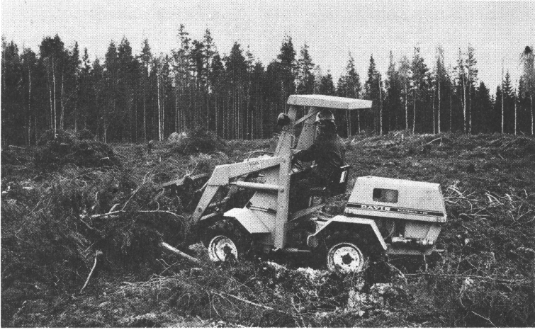
Kuva 7. Davis Scatback 430 pyöräkuormaaja Fig. 7. Davis Scatback 430 wheel loader
