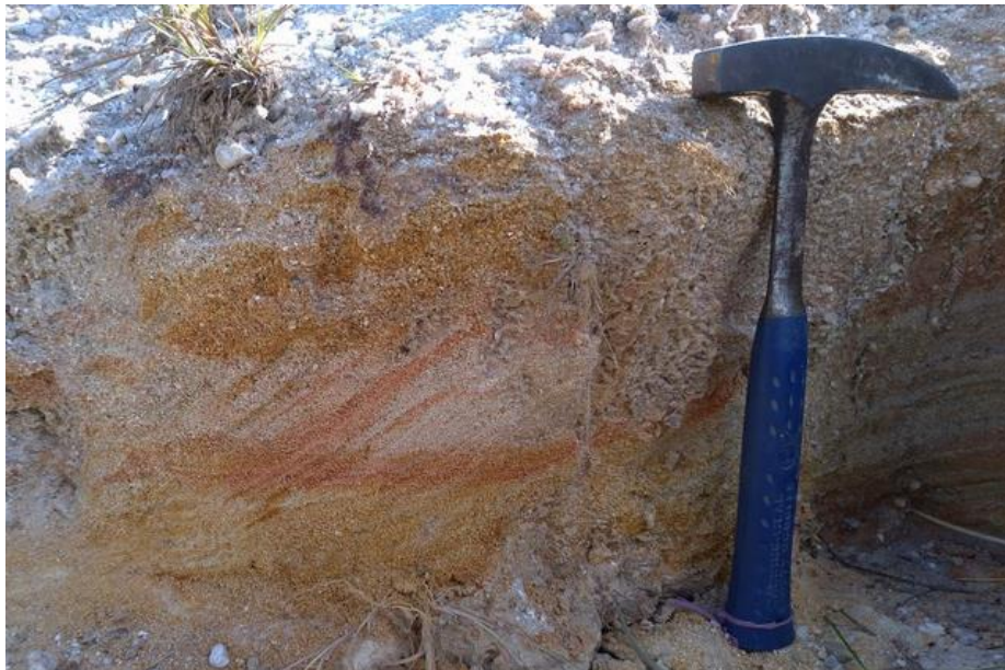
Figura 21 – Camadas areníticas nas quais é possível identificar diferentes tonalidades da precipitação de óxidos/hidróxidos de ferro associadas à trama sedimentar. Nesse caso, o foreset das estruturas cruzadas é delineado por cimentação avermelhada, e a cimentação associada aos limites entre sets por coloração amarela-avermelhada.
