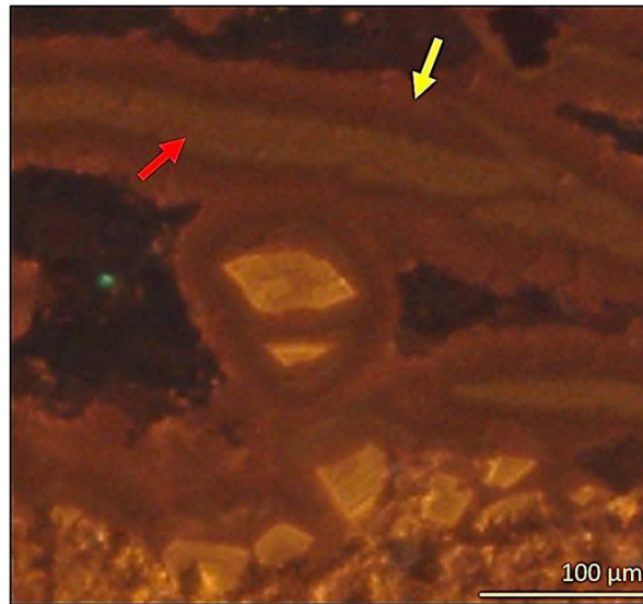
Figura 27: Imagem de catodoluminescência (CL) da lamela contínua de dolomita, na profundidade x109,55. Notar a borda de dolomita com cor avermelhada mais escura (seta amarela), e no centro da lamela, a cor esverdeada, como resposta ao teor de Si presente na lamela. Obs: Brilho e contraste foram ajustados para visualizar melhor as feições.
