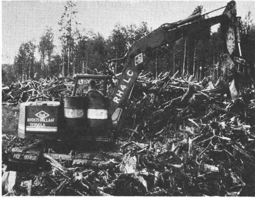
Kuva 18. Pallarin kantoharvesteri paloittelussa. Fig. 18. The splitting of stump and moor wood by the Pallari Stumpvester.
