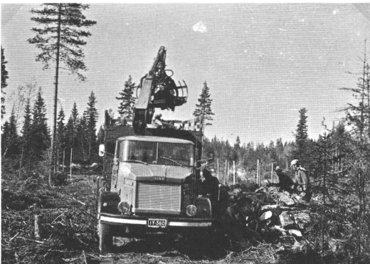
Kuva 3. Auton kuormausta hydraulikuormaimella (Reitti III).
