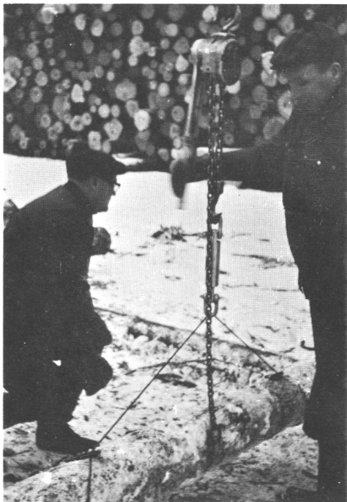
Kuva 3. Tukin punnitseminen dynamometrillä. Fig. 3. Weighing of a sawlog by dynamometer.
