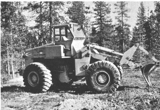
Kuva 2. Allis-Chalmers TL-645 varustettuna kantokauhalla.
