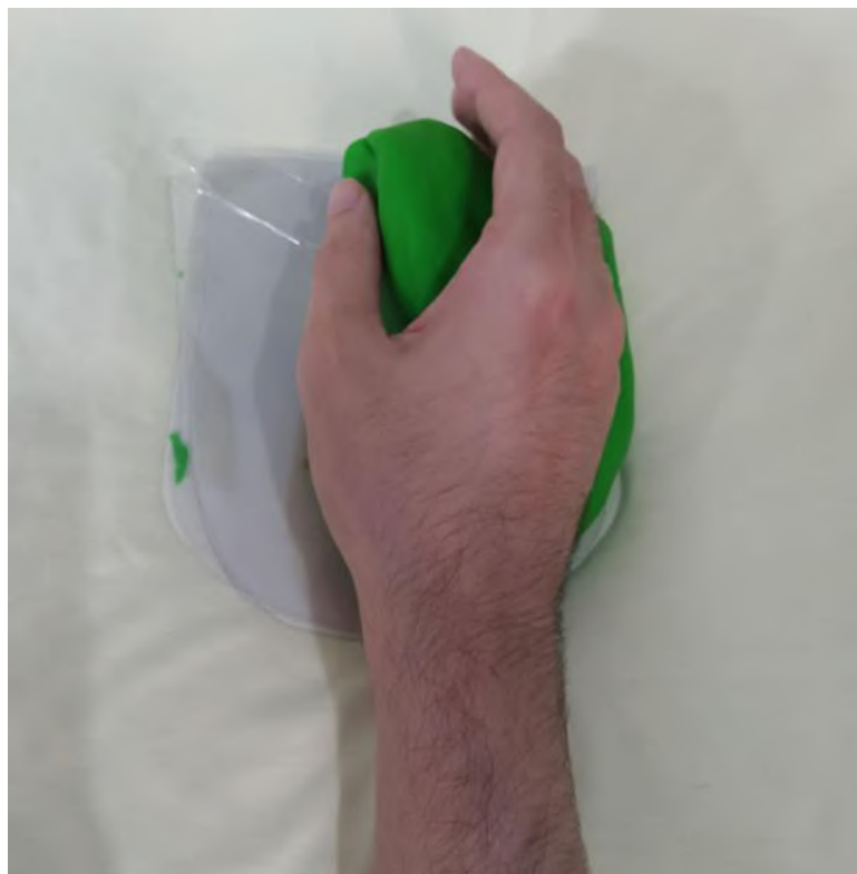
Figura 121. Teste no mouse vertical com a integração do apoio lateral direito e apoio de pulso, realizado por um homem do percentil 50% (vista superior)
