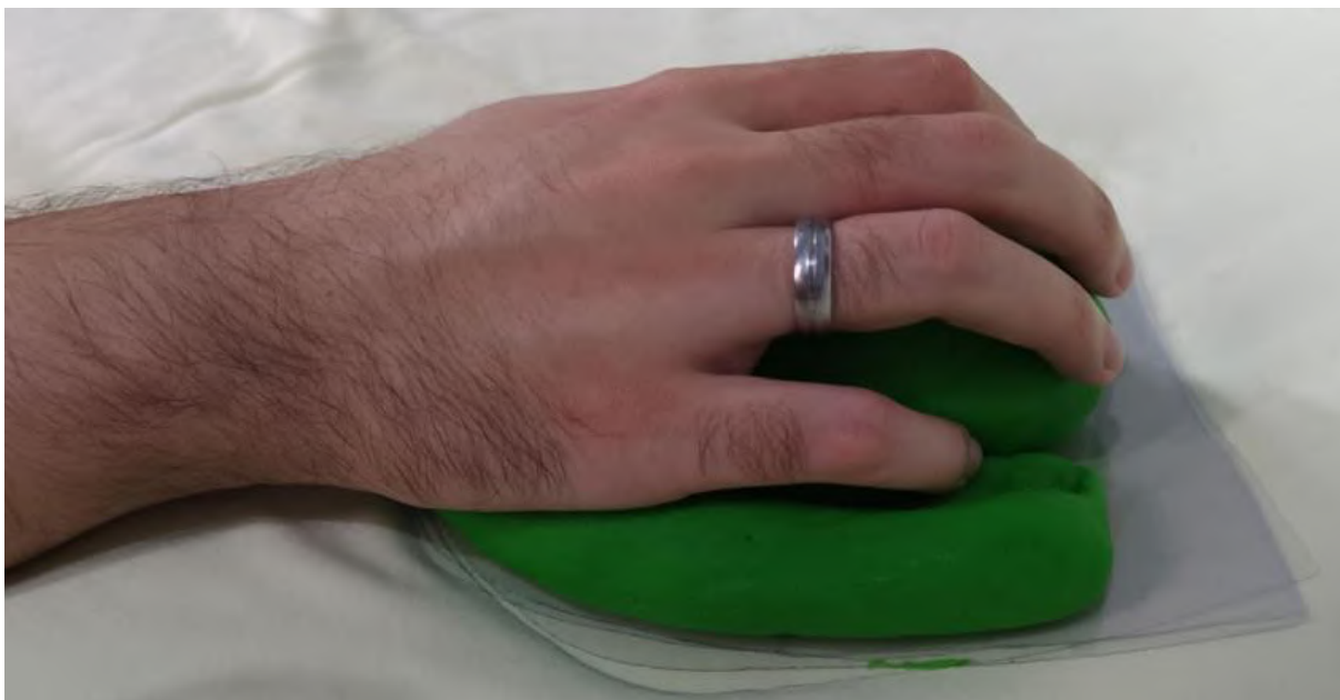
Figura 113. Teste no mouse grande com a integração do apoio lateral direito e apoio de pulso, realizado por um homem do percentil 50% (vista lateral direita)
