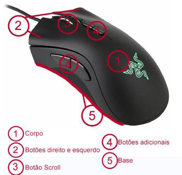
Figura 5. Elementos do mouse.
