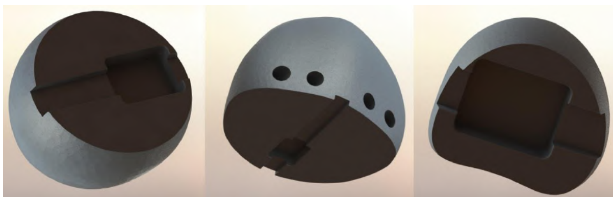
Figura 166. Cortes dos encaixes para as travas e pinos em cada peça
