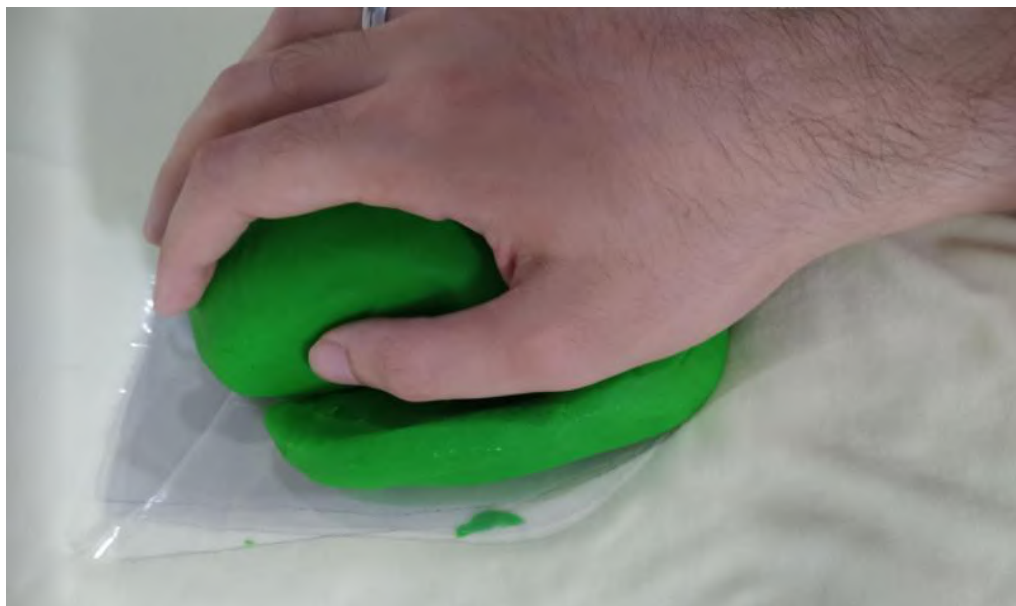
Figura 115. Teste no mouse grande com a integração do apoio lateral direito, apoio de pulso e apoio lateral esquerdo encaixado, realizado por um homem do percentil 50% (vista lateral esquerda)
