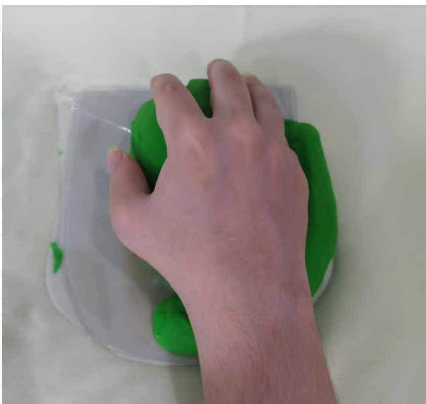
Figura 106. Teste no mouse grande com a integração do apoio lateral direito e apoio de pulso, realizado por uma mulher do percentil 5% (vista superior)
