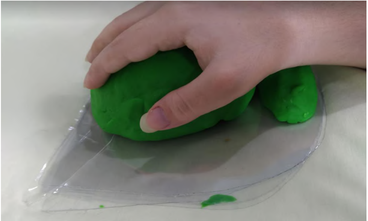
Figura 107. Teste no mouse grande com a integração do apoio lateral direito e apoio de pulso, realizado por uma mulher do percentil 5% (vista lateral esquerda)
