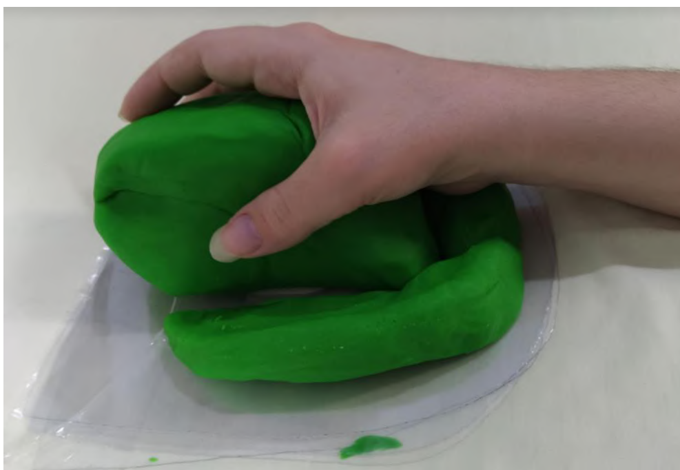
Figura 120. Teste no mouse vertical com a integração do apoio lateral direito, apoio de pulso e apoio lateral esquerdo encaixado, realizado por uma mulher do percentil 5% (vista lateral esquerda)
