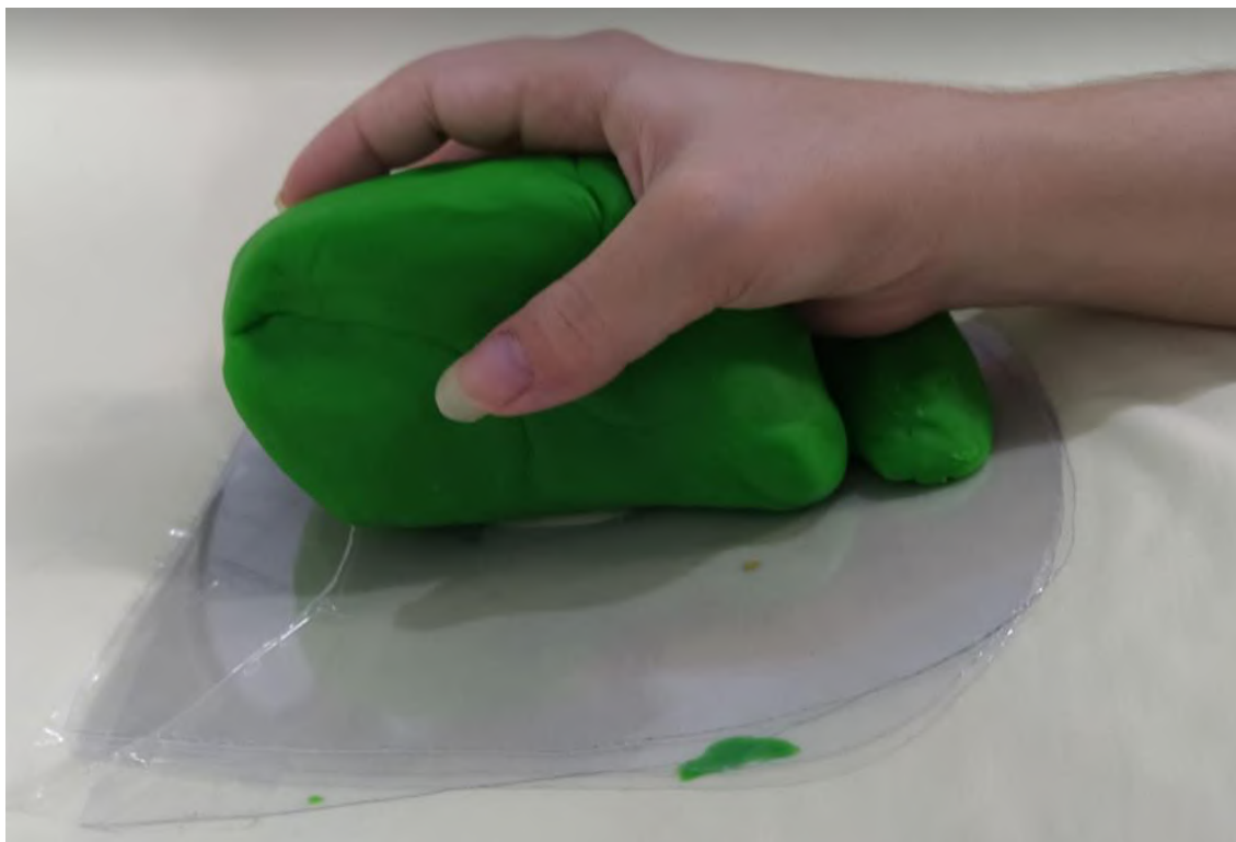
Figura 117. Teste no mouse vertical com a integração do apoio lateral direito e apoio de pulso, realizado por uma mulher do percentil 5% (vista lateral esquerda)
