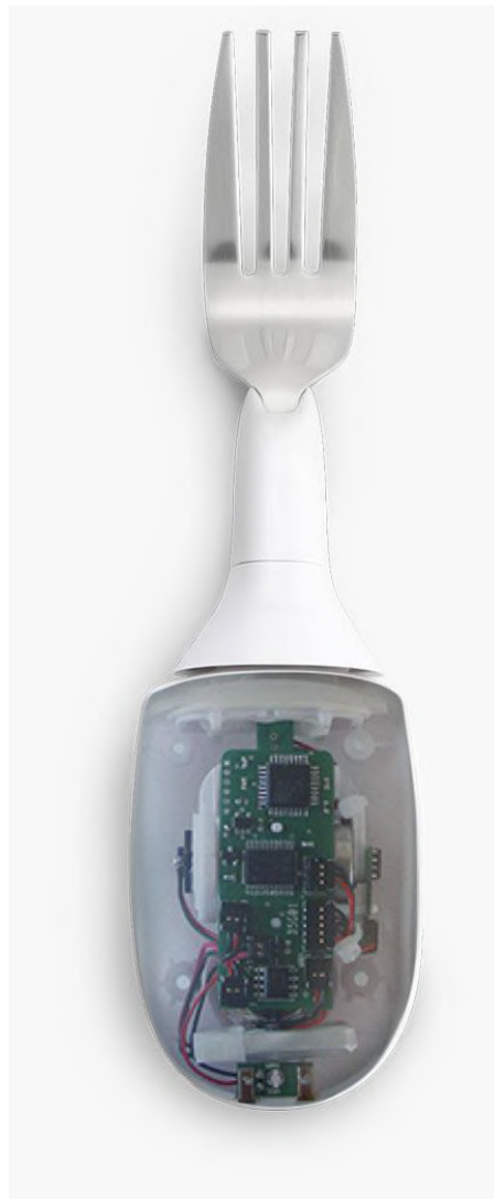
Figura 23. Demonstração do interior da pega da Liftware, com a placa de circuito e motores que realizam o funcionamento do dispositivo. Fonte: https://www.liftware.com/steady/
