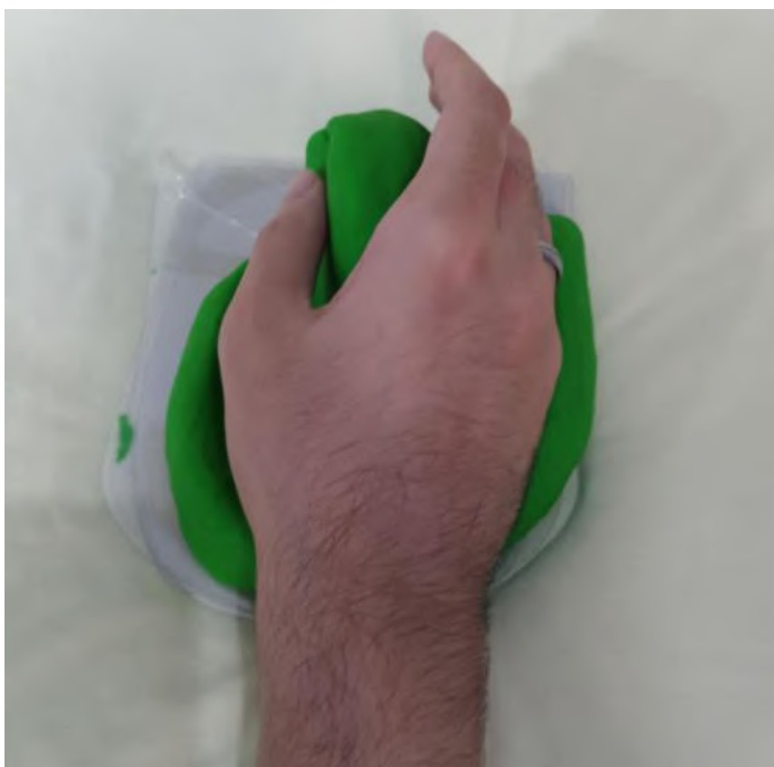
Figura 124. Teste no mouse vertical com a integração do apoio lateral direito, apoio de pulso e apoio lateral esquerdo encaixado, realizado por um homem do percentil 50% (vista superior)
