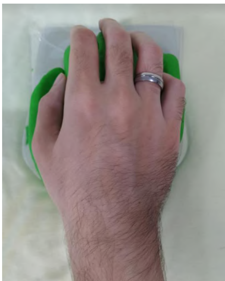
Figura 114. Teste no mouse grande com a integração do apoio lateral direito, apoio de pulso e apoio lateral esquerdo encaixado, realizado por um homem do percentil 50% (vista superior)
