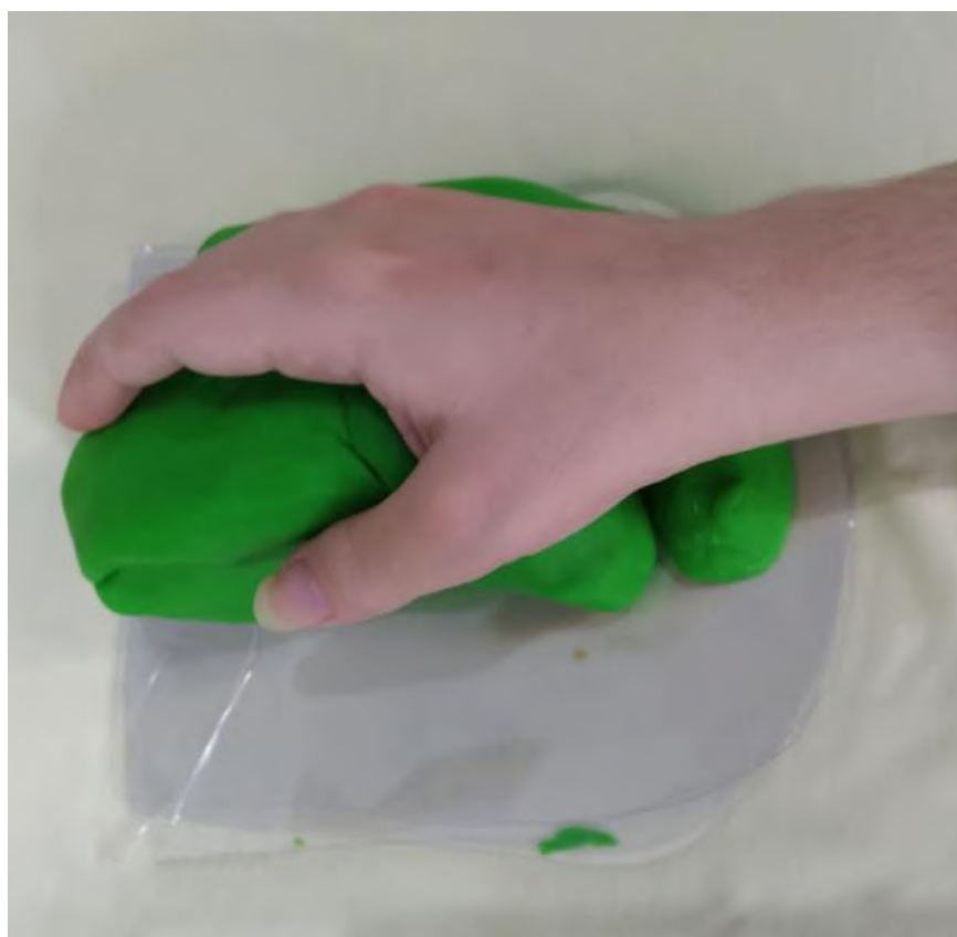
Figura 116. Teste no mouse vertical com a integração do apoio lateral direito e apoio de pulso, realizado por uma mulher do percentil 5% (vista superior)
