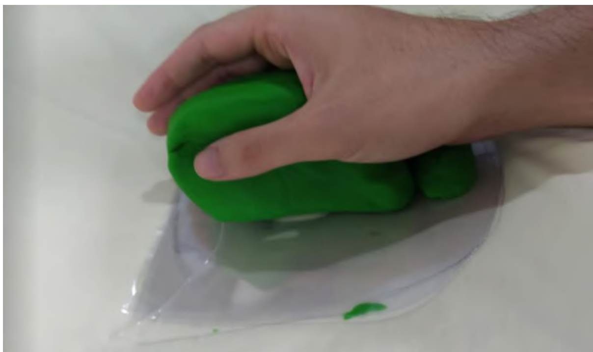
Figura 122. Teste no mouse vertical com a integração do apoio lateral direito e apoio de pulso, realizado por um homem do percentil 50% (vista lateral esquerda)
