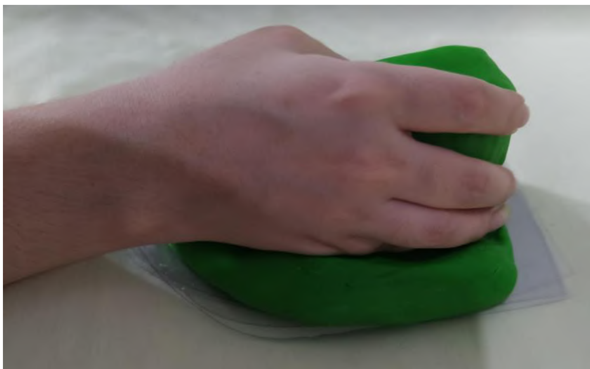
Figura 118. Teste no mouse vertical com a integração do apoio lateral direito e apoio de pulso, realizado por uma mulher do percentil 5% (vista lateral direita)
