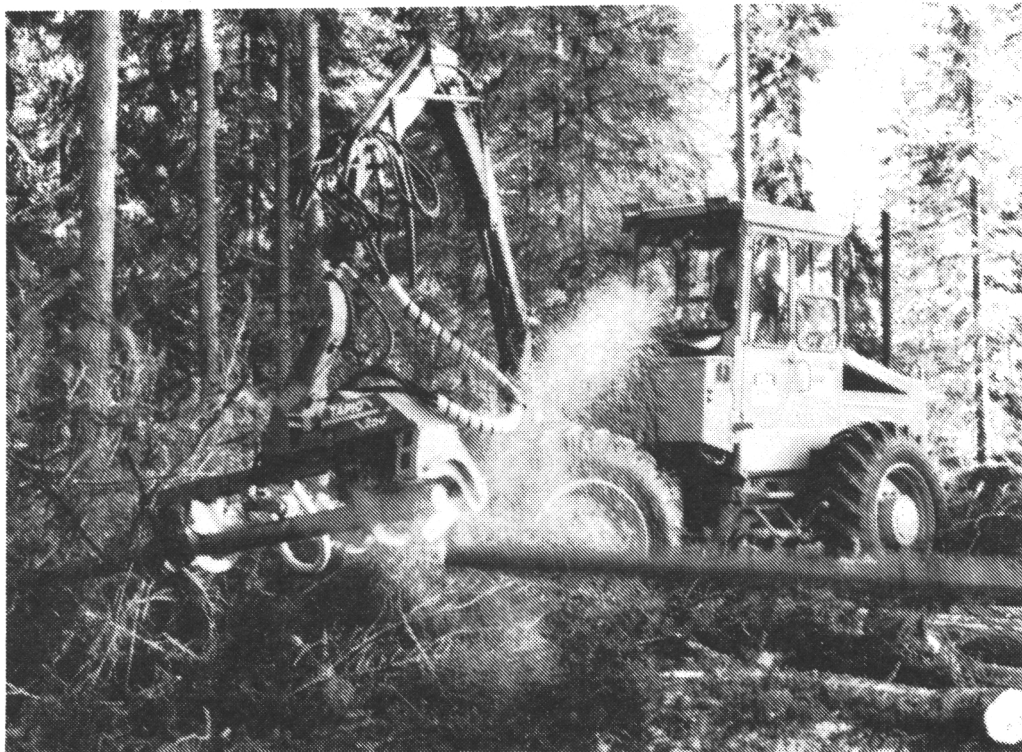
Kuva 1. Tapio 250 -yksioteharvesteri, peruskoneena LKT 81 -traktori.
