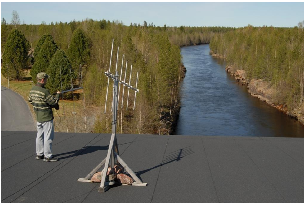
Kuva 3. Radiolähettimellä merkittyjen lohen vaelluspoikasten seurantaa varten lijoen alajuoksun voimalaitoksille asennettiin automaattisia radiovastaanottimia antenneineen. Kuvassa Haapakosken voimalaitoksen alavirran puoleinen antenni. Kuva: P. Orell.
