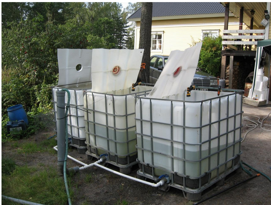
Kuva 12. Noin kuution muovisäiliöt toimivat hyvinä rapualtaina. Vesi kierrätettiin pumpun avulla takaisin säiliöihin hapettavien pistoolisuuttimen kautta. Kiertoon lisättiin automaattisesti viileää porakaivovettä. Muovisäiliöiden sisällä oli päällekkäin matalia verkkosumppuja, kullekin rapujen kokoluokalle omansa.
