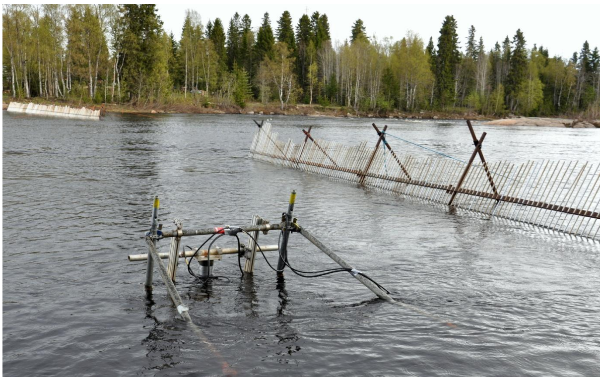
Kuva 2. Kuvassa näkyvien ohjaisaitojen välinen matka on noin 40 m. DIDSON on kiinnitetty helposti siirrettävään telineeseen.
