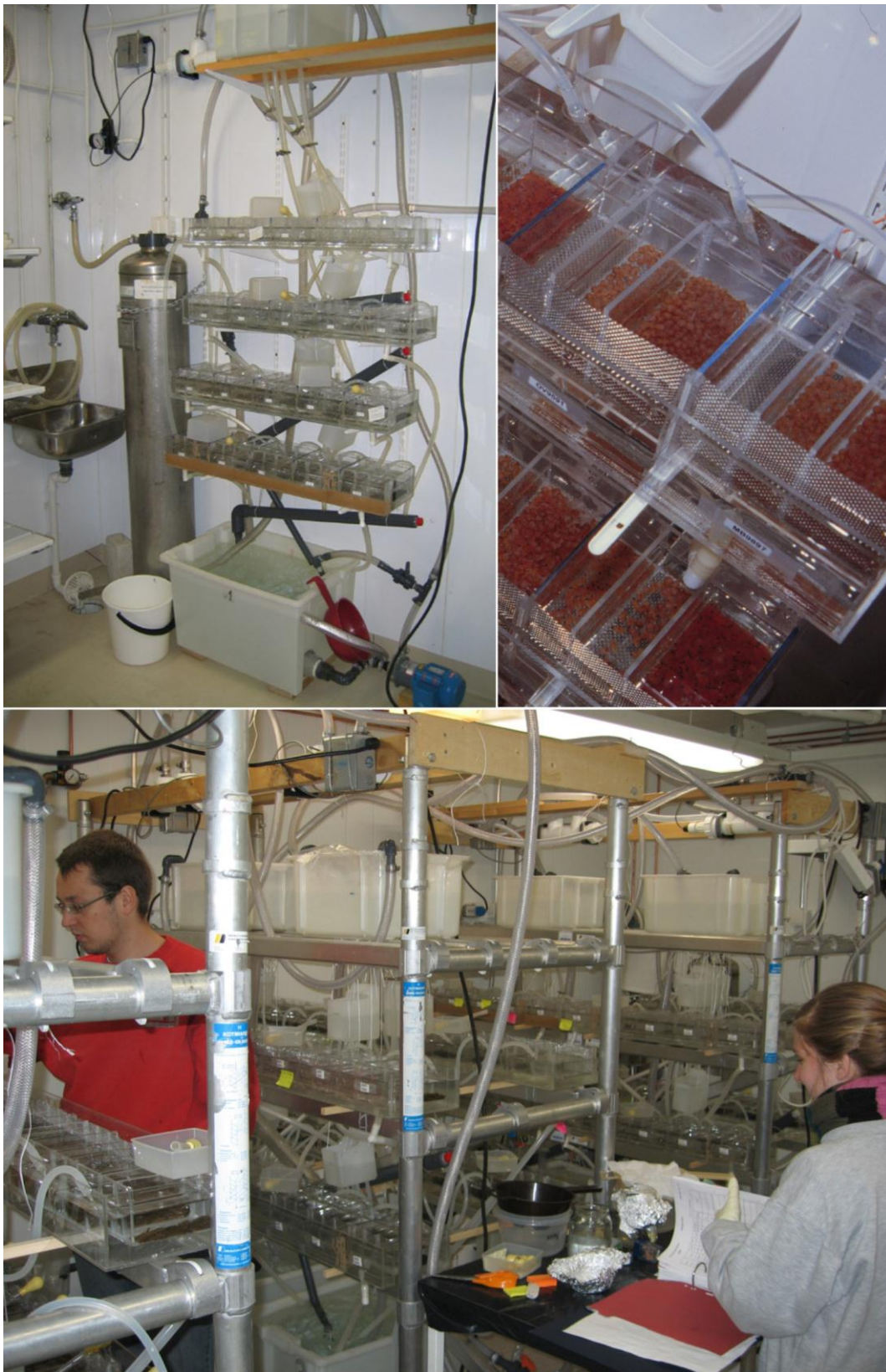
Kuva 11. Laboratoriohaudonnan koejärjestelyssä tulovesi suodatetaan aktiivihilipylvään (teräslieriö) läpi ja vesi kierrätetään magneettiventtiilipumpun avulla UV-valolähteen (valkoiset lieriökotelot ylhäällä) kautta kierto-veden desinfiointiseksi. Lähikuvassa on viiden mätierän haudonta-asetteja, joissa kullekin mätierälle on oma kolmilokeroinen osastonsa (rajattu sinisellä). Vesi virtaa aseteille takakourusta alakautta munakerroksen läpi, poistuu etuverkon läpi viemärikouruun ja valuu edelleen pumppualtaaseen. Kuvat Pekka J. Vuorinen.
