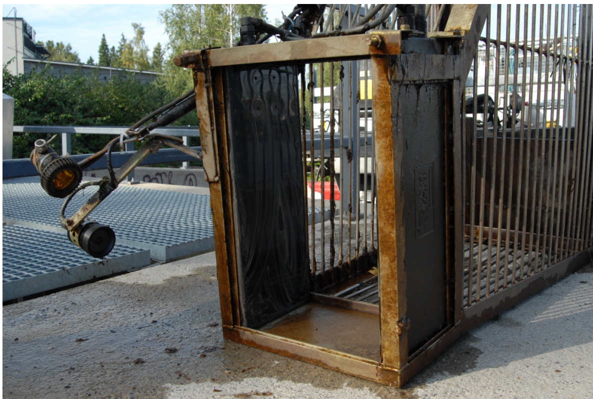
Kuva 18. Oulujoen Merikoskella käytetty VAKI-kalalaskurin vedenalaisyksikkö ja siihen kiinnitetty vedenalainen videokamera (alempi) ja halogeenivalo (ylempi). Kuva: Panu Orell.
