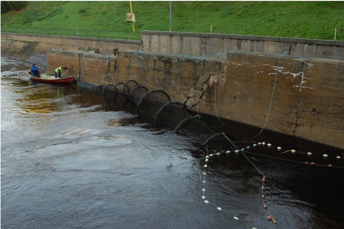
Kuva 15. Vuosina 2011–2012 Merikoskella käytetyn rysän pyyntisuunta vaihdettiin ja aitaverkosta luovuttiin. Rysän suuaukko avautui ylävirtaan ja se sijaitsi vain muutaman metrin voimalan alapuolella. Kuva: Panu Orell.
