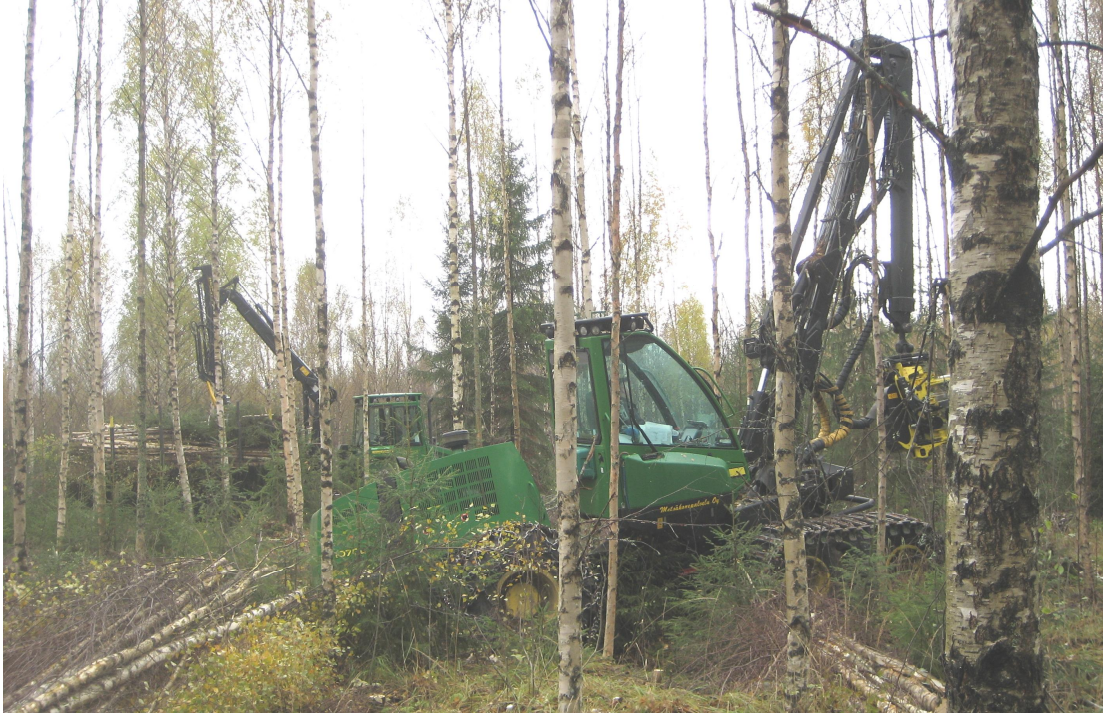
Kuva 29. Energiapienpuun koneellista korjuuta koivikon harvennuskohteella Itissä syksyllä 2009. Kuva: Jarno Föhr.
