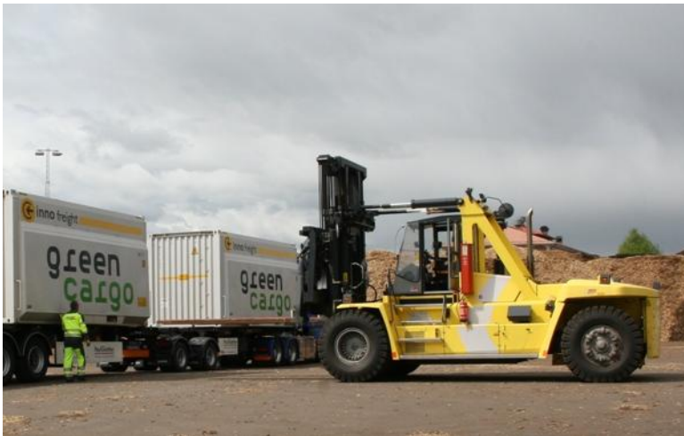
Kuva 18. Hakekonttien purkua haarukkatrukilla. Kuva: Innofreight Speditions GmbH.
