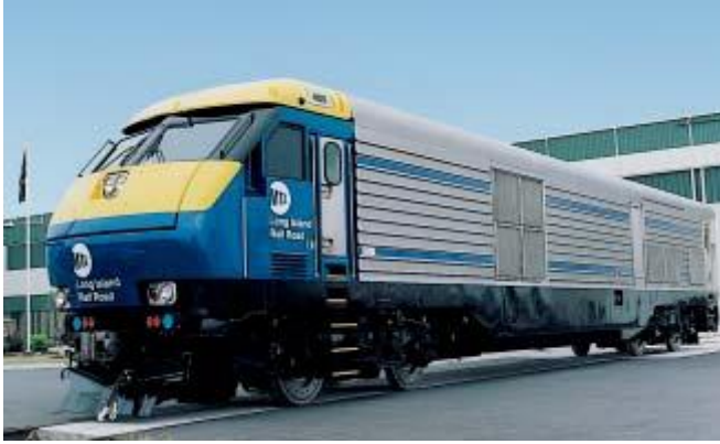
Kuva 17. DM30AC – veturi, joka kulkee vaihtoehtoisesti joko sähköllä tai dieselillä. Kuva: Siemens AG, Transportation Systems.
