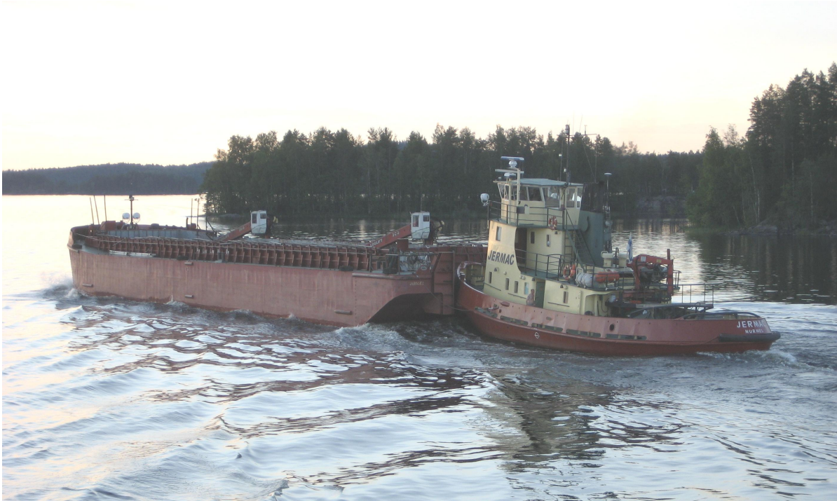
Kuva 20. Hinaajan ja proomun muodostama työntökytkye. Kuva: Kalle Karttunen.
