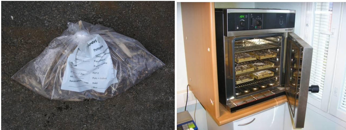
Kuva 35. Vasemmalla kosteusnäytepussi ja oikealla kosteusnäytteet uunikuivauksessa.
