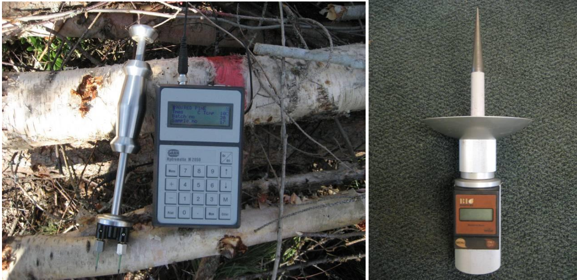
Kuva 36. Kosteutta mittaavia laitteita. Vasemmalla Hydromette M 2050 ja oikealla Bio Moisture.
