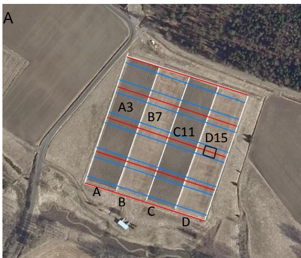
Kuva 1. Kotkanojan 16-ruutuinen huuhtoutumiskenttä Jokioisilla. Siniset viivat kuvaavat salaojia ja punaiset ruutujen rajoja. Pintavaluntaruudut on erotettu valkoisilla viivoilla. Lohkot A ja C kynnettiin syksyllä ja lohkot C ja D kylvettiin suorakylvökoneella. Pintavalunta kerättiin 4 lohkolta (A, B, C ja D) ja salaojavalunta 4 ruudulta (A3, B7, C11 ja D15).
