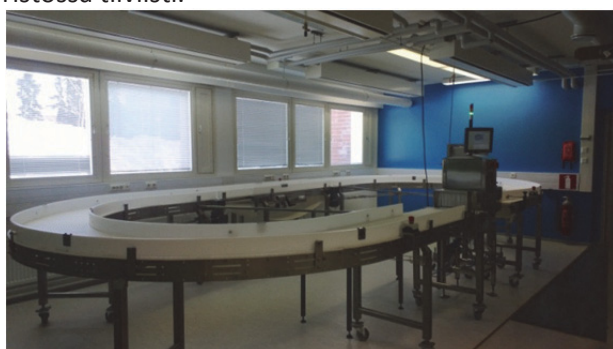
Kuva 44. FSC toimintaympäristön vierasesinetunnistuksen testirata mittalaitteineen.
