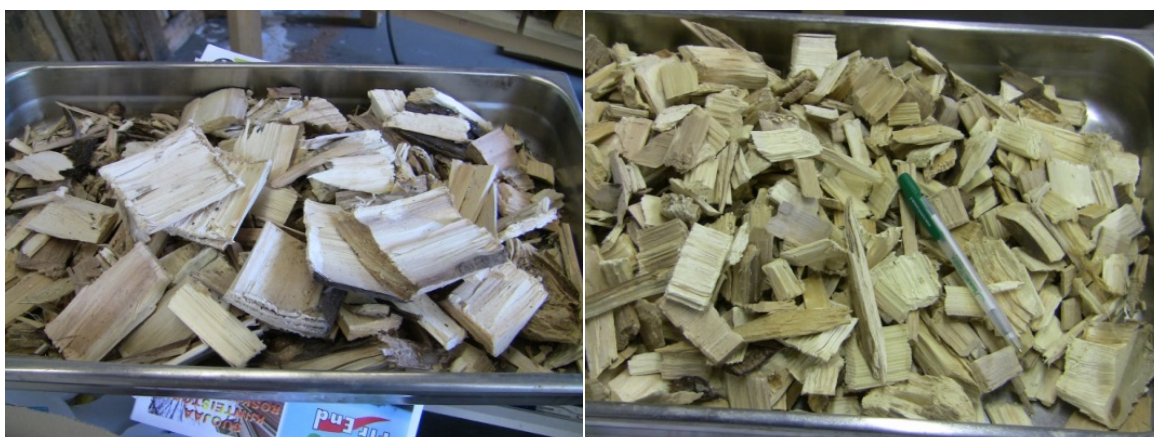
Kuva 4. Kokeissa käytettyä haketta, kosteus noin 13,5 % (vas karkeampaa haketta, oik pienempää). Osa ajoista ajettiin oikean kuvan mukaisella hakkeella, josta hienoainesta ei oltu seulottu pois.
