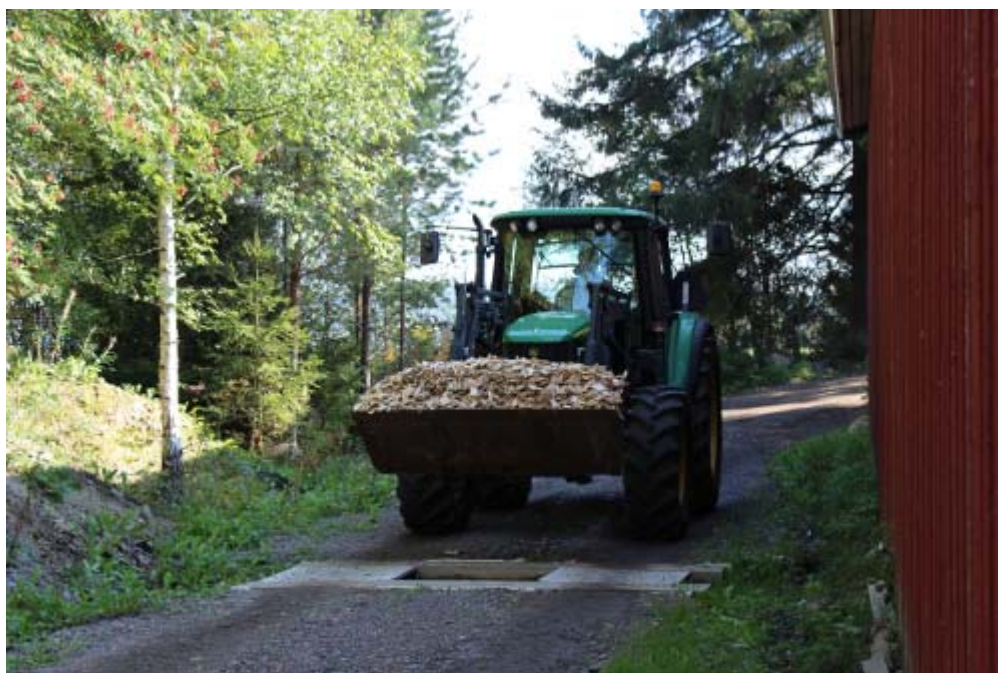
Kuva 7. Hoviin asennetun ajoneuvovaa’an avulla punnittiin viljaerien painot ja hankkeen kulutus. Vaa’an tarkkuus on \pm 5 kg.
