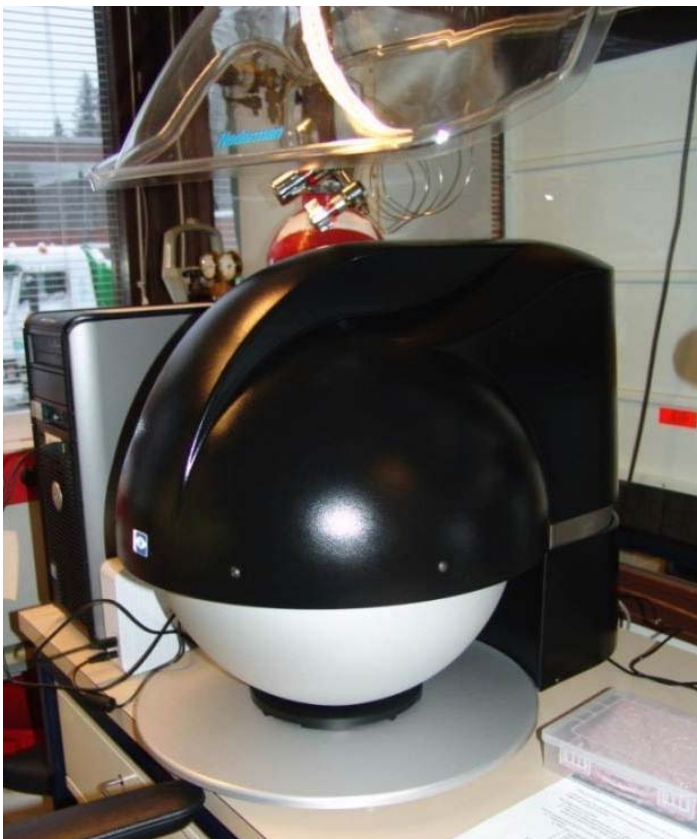
Kuva 3. Monialaiseen kuvantamiseen perustuva VideometerLab-laite.
