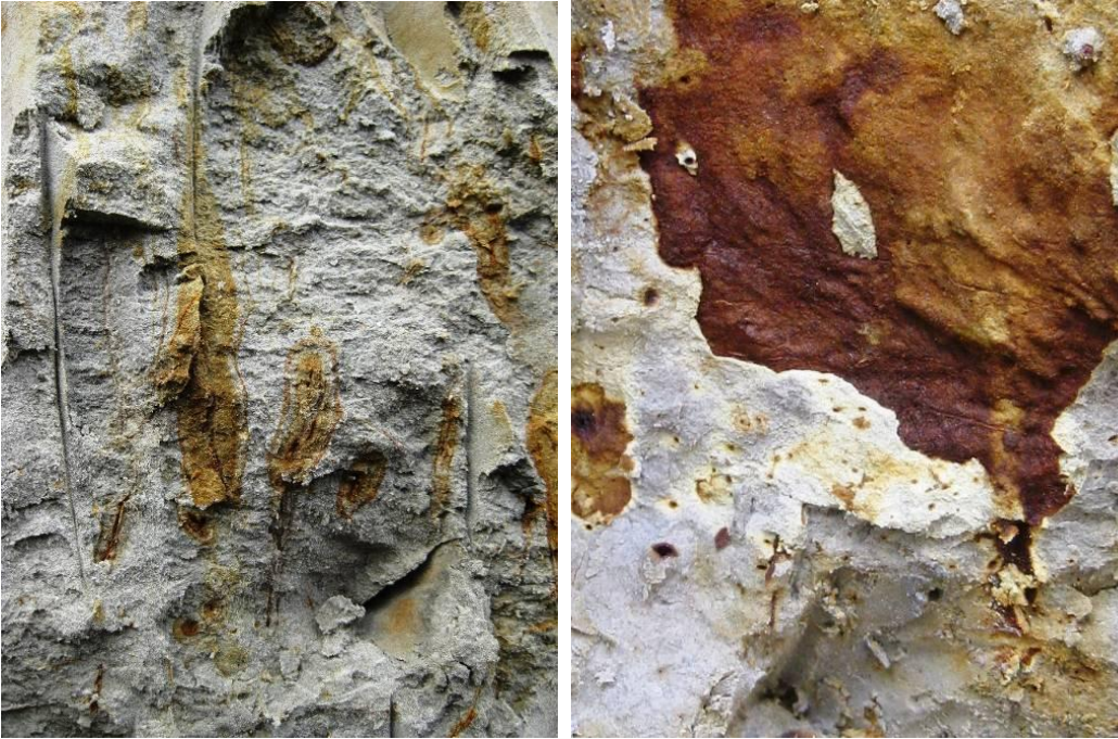
Kuva 3. Maassa 72-94 cm:n syvyydessä (vasemmalla) on suuria juurikanavien ympärille syntyneitä rautasaostumia. Tämän horisontin alla 94-118 cm:n syvyydessä (oikealla) on halkeamapinnat kokonaan peittäviä kovia rautasaostumia. Keltaisena näkyvä mineraali on sulfidien hapettumisen välituotetta, jarosiittia, josta vapautuu edelleen happamuutta. Sitä on usein myös kokkareiden vähemmän huuhtoutuneissa sisäosissa.
