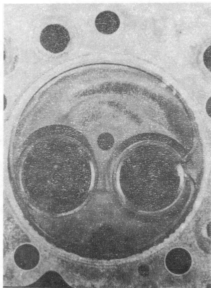
Kuva 4.6.3 Pakoventtiin väliin taipunut kannetiivisteiden liekkirengas
