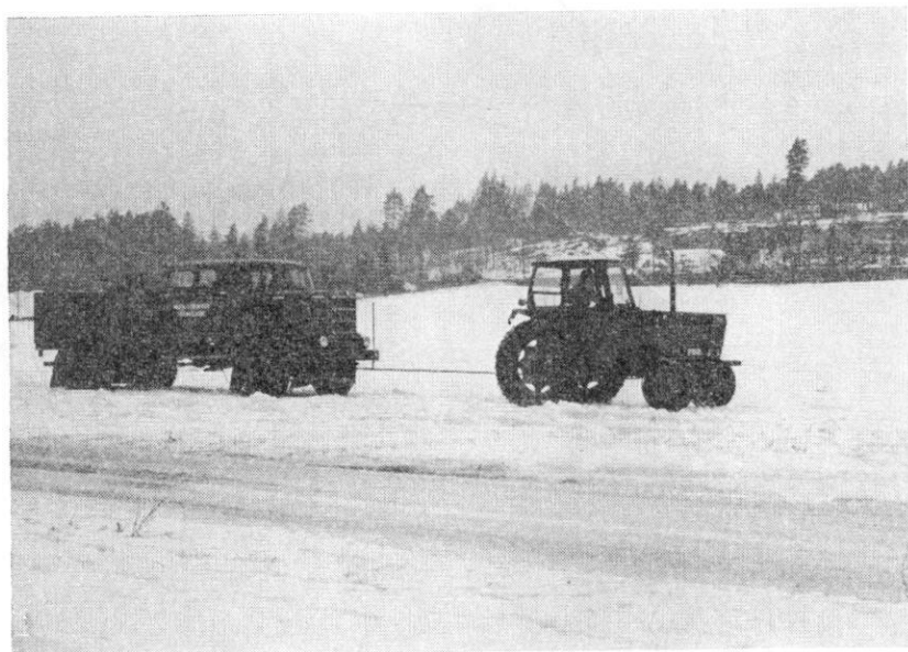
Kuva 4. Traktorin vetovoiman mittaus VAKOLAn jarruautolla — Tractor on draw-bar test.
