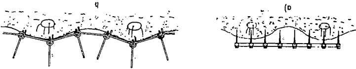
Kuva 7. Jäykkärunkoinen rikkaruohoäes (a) vioittaa perunan taimia. Niveltyvä verkkoäes irrottaa rikkakasveja myös penkin luiskasta (b).
