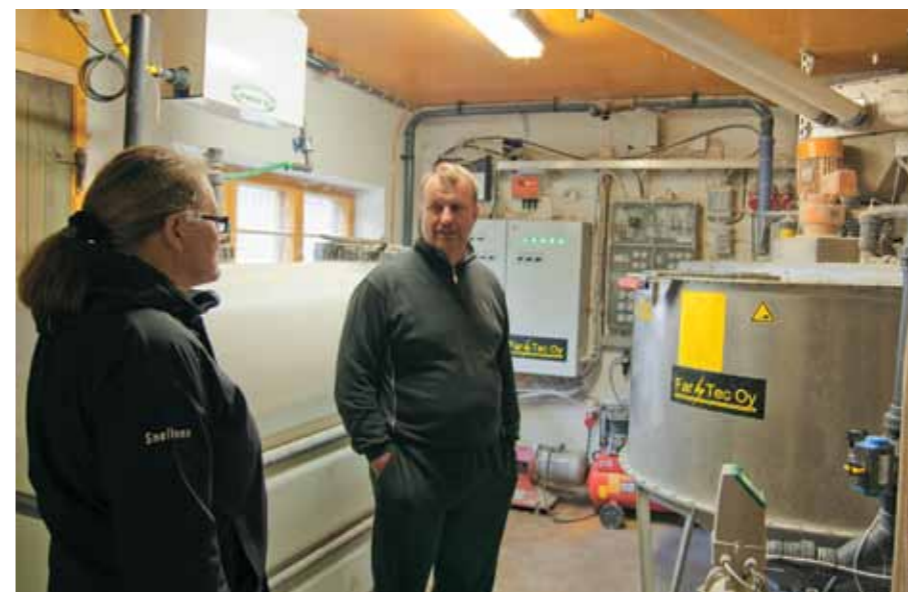
Pauli Perho ja Snellmanin MP-rehupäällikkö Kirsi Partanen keskustelevat rehuseurannan tärkeydestä. Tewe-liemi-ruokintajärjestelmän avulla Pauli Perho voi seurata sikojen rehunkulutusta reaaliajassa, jopa imisä- ja leikkokarsinoista erikseen.
