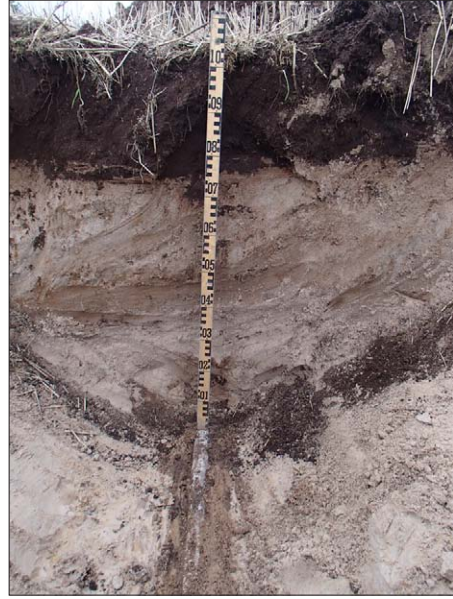
Kuva 2.5. Tyypillinen koekuopan maaprofiili karkeilla mailla (hieta/hiekka).
