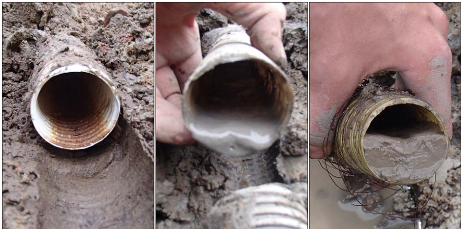
Kuva 3.70. Putkien tukkoisuus vaihteli puhtaasta lähes kokonaan tukkeutuneeseen putkeen.
