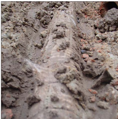
Kuva 3.56. Kalajoki 3. Suodatinkangas oli hajonnut ohueksi.
