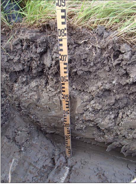
Kuva 2.4. Tyypillinen koekuopan maaprofiili savimailla. Pinnassa on noin 20 cm multavaa maata.
