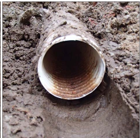
Kuva 3.57. Kalajoki 3. Putket olivat puhtaita koko lohkolla.
