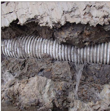
Kuva 3.51. Lieto. Suodatinkangas oli hajonnut täysin.
