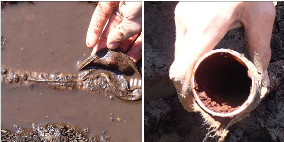
Kuva 3.58. Ristiina. Kangas on säilynyt maassa 15 vuoden ajan, mutta se oli ohentunut merkittävästi. Hajoamista oli vähemmän lohkon yläosissa.
