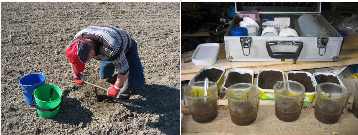
Kuvat 4. ja 5. Maanäytteiden otto kevätvehnän lannoituskoealueelta kahdesta eri syvyydestä, 0-25 cm ja 25-50 cm, ja nitraattitypen määrittäminen typpilaukulla. (Kuvat: Pirjo Kivijärvi/MTT)
