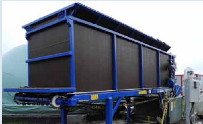
MTT Maaningan maatilakohtaisen biokaasulaitoksen automatisoitu säilörehun syöttölaite. Kuva: Jenni Airaksinen/MTT.
