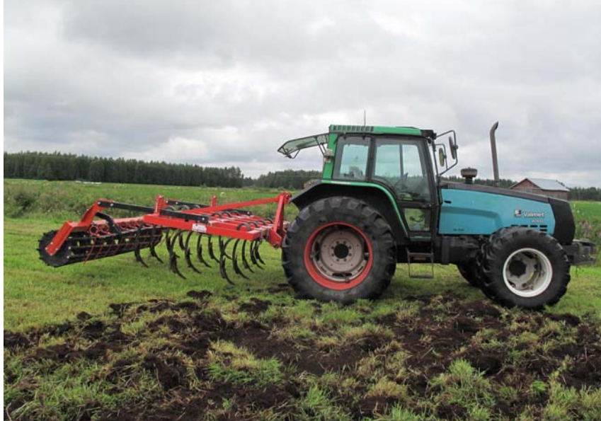
Kultivaattori silmukajousin ja putkipakkerilla
