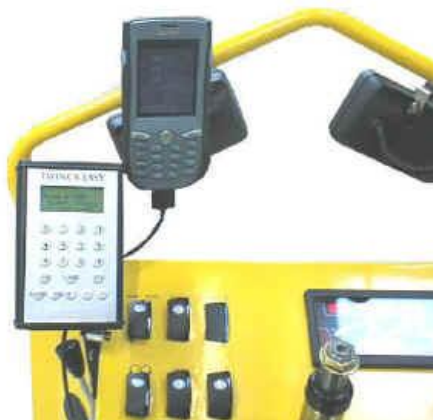
Kuva 11. TwincaStep-laitteisto asennettuna trukkiin
