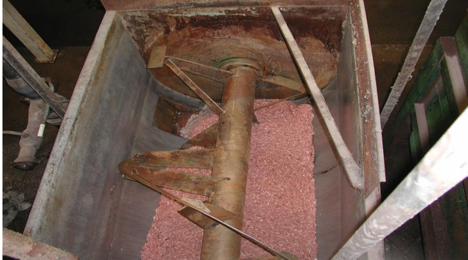
Kuva 4. Koerehun valmistus käynnissä. Yhdellä täydellä sekoittimella voidaan valmistaa kerralla jopa kymmenen tonnin rehuannos. Kuva MTT.
