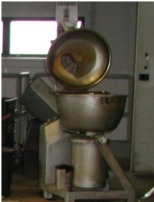
Kuva 3. Pienten koerehuerien valmistukseen käytettävä sekoitin. Kuva: Pekka Eskeli.
