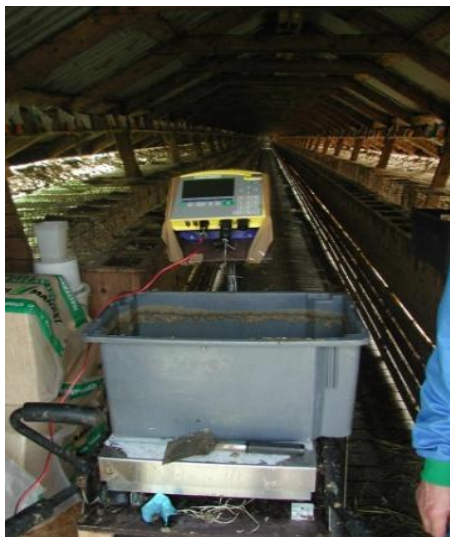
Kuva 13. Perinteinen vaaka koerehun annostelussa. Rehulaatikko on vaa'an päällä ja se on muistettava taarata jokaisen punnitun rehuannoksen jälkeen. Kuva Pekka Eskeli
