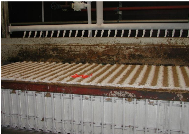
Kuva 5. Yhdessä levypakastimessa voidaan pakastaa n. kolme tonnia rehua neljässä tunnissa. Kuva: MTT.
