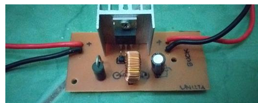
Gambar 17. Bentuk Fisik Buck Converter
