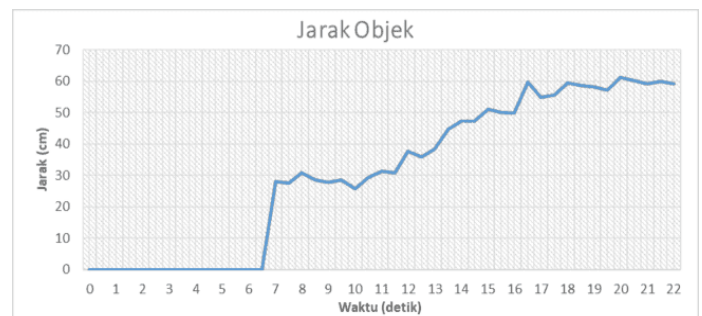
Gambar 15. Pengukuran deteksi jarak objek dinamis menjauh
