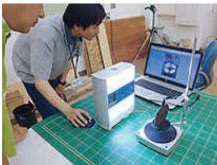
図9 固定式3Dレーザースキャナー
