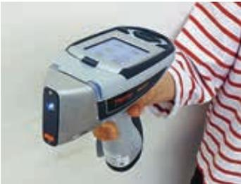
図3-1 蛍光X線分析に用いる装置
