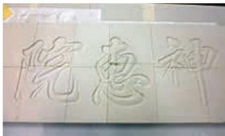
図17 3Dプリンターによる打ち出し結果
