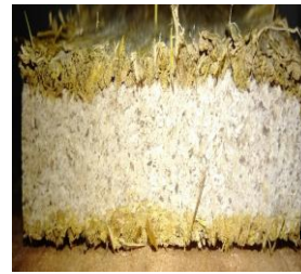
Gambar 4. Kondisi UF yang tidak tercampur merata pada sampel kerapatan tinggi (1,0 g/cm 3 )
