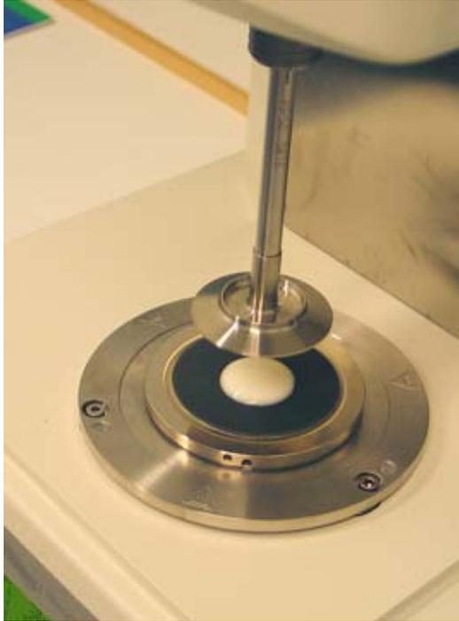
*Jogurtinäytteen reometrinen mittaus alkamassa. Kuvassa näkyvä pyöreä metallitaso lasketaan alas, niin että jogurtti jää ohueksi kerrokseksi alustan ja metallitason väliin.*
