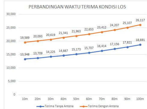
Gambar 10. Grafik Perbandingan Nilai Pancar Dengan Antena Dan Tanpa Antena Kondisi LOS
