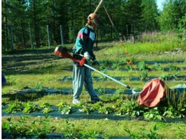
Piharatomon siemeniä kerättiin Ketolan taimitarhalla Kemijärvellä kesällä 2003 raivaussahaan kehitetyllä laitteistolla.
