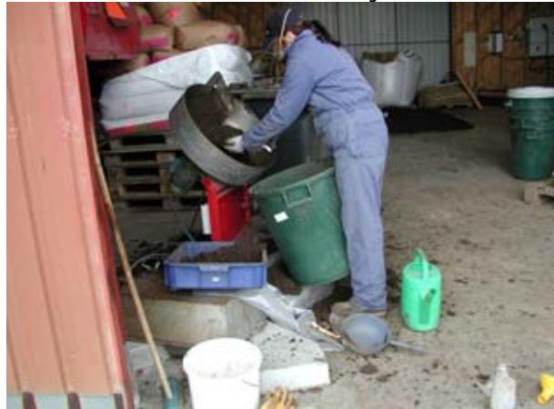
Kompostituhkarakeet valmistettiin rakeistamalla kompostin ja tuhkan seosta rakeistuslautasella.
