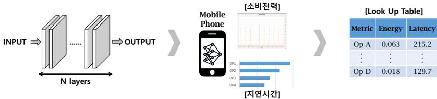
그림 11: 오퍼레이션 모델 측정 및 LUT 생성 방법
