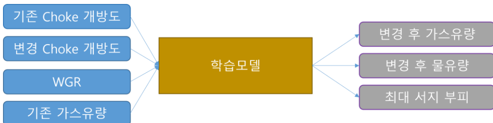
그림 14. Rakhine Basin 필드 모델을 활용한 순방향신경망 학습모델의 구조
