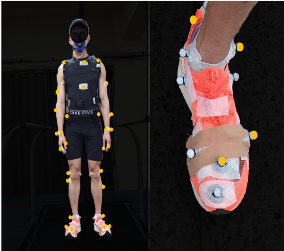
그림 4. 전신 마커 부착위치 (왼), 발의 마커 부착 위치(오)
