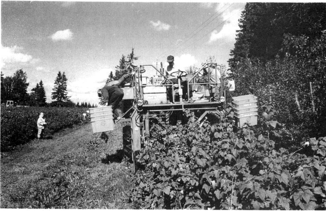
Kuva 15. Herukkakokeiden sadonkorjuuta Joonas-herukkapuimurilla.
