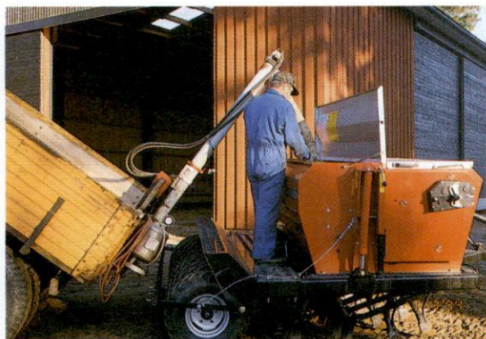
Bild 8. Av en vanlig tippvagn kan man med hjälp av påfyllningsskruv få en billig, säker och ändamålsenlig påfyllningsvagn.
