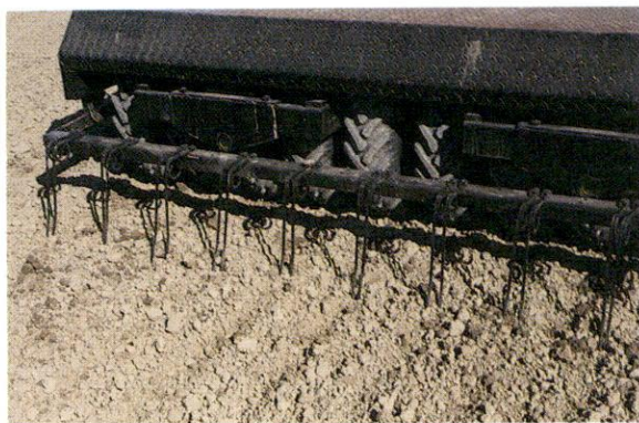
Bild 16. Efterharven bakom välthjulen utjämnar åsen mellan hjulen över hjulspåren.
