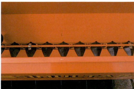
Bild 6. Behållarnas bottenkoner är till nytta speciellt vid sådd av småfrön.
