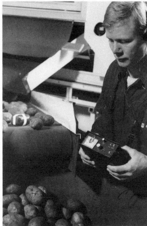
Kuva 30. Mittauksissa käytetty tanskalainen sähköperuna vastaanottiminen (kuva käyttöohjeesta).
