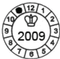
Kuva A8. a) Tehdyn varmentamisen ilmaiseva merkki. Tässä esimerkissä varmennus on tehty marraskuussa 2009. b) Suomalainen sinetöintimerkki.
