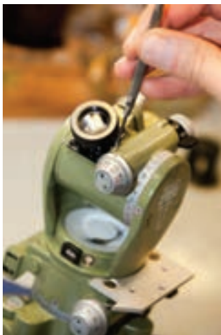
Kuva 4.6 Kalibrointi ja viritys. Kalibrointi tarkoittaa mittarilukemien ja suureen todellisten arvojen välisen riippuvuuden selvittämistä. Virityksessä säädetään mittarilukemat vastaamaan todellisia arvoja.
