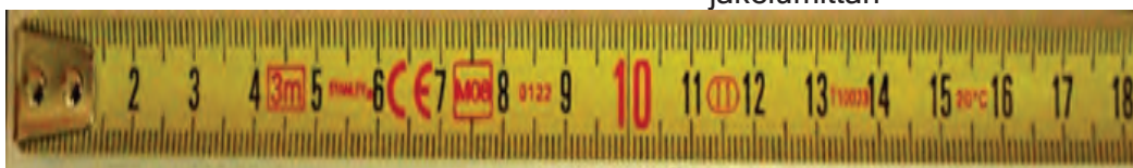
Kuva A3. Rullamitta mittauslaitedirektiivin mukaisin merkinnöin.
