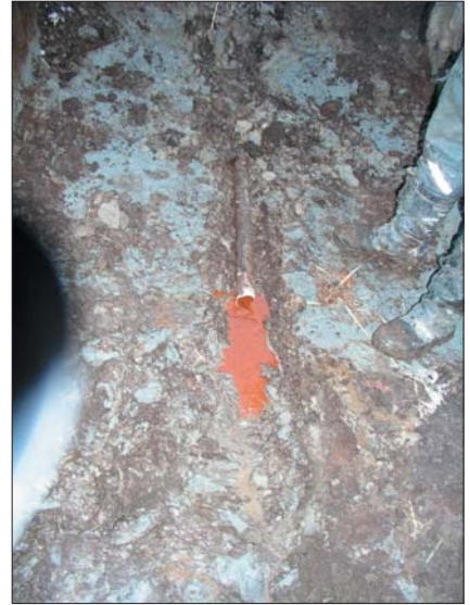
Kuva 8.9. Esimerkki Leppävirran kohteesta. Maalaji on ojitussvyvydessä hiesusavi ja maan savespitoisuus on 48 %. Ojitus on tehty vuonna 2005. Rautasaostumia näkyy salaojavedessä.
