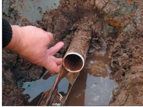
Kuva 8.6. Kalajoki. Viisi vuotta vanha täydennysojitus ohuella esipäälysteellä perunan viljelyssä olleella pellolla. Pintamaan maalaji on hietaa ja savespitoisuus 1 %. Salaojasyvydessä maalaji on hiesusavi ja savespitoisuus 51,7 %. Putkessa näkyy vain vähän ruostesaostumia.
