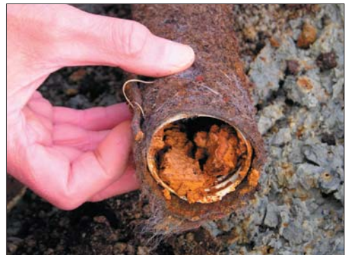
Kuva 8.4. Alavieska, kohde 2. Viisitoista vuotta vanha ensiojitus esipäällysteellä kookoskuitu. Pohjamaa on hieua ja savespitoisuus 28 %.
