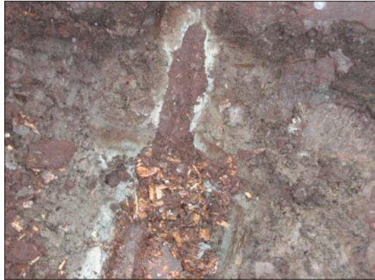
Kuva 8.6. Kalajoki. Viisi vuotta vanha täydennysojitus ohuella esipäälysteellä perunan viljelyssä olleella pellolla. Pintamaan maalaji on hietaa ja savespitoisuus 1 %. Salaojasyvydessä maalaji on hiesusavi ja savespitoisuus 51,7 %. Putkessa näkyy vain vähän ruostesaostumia.
