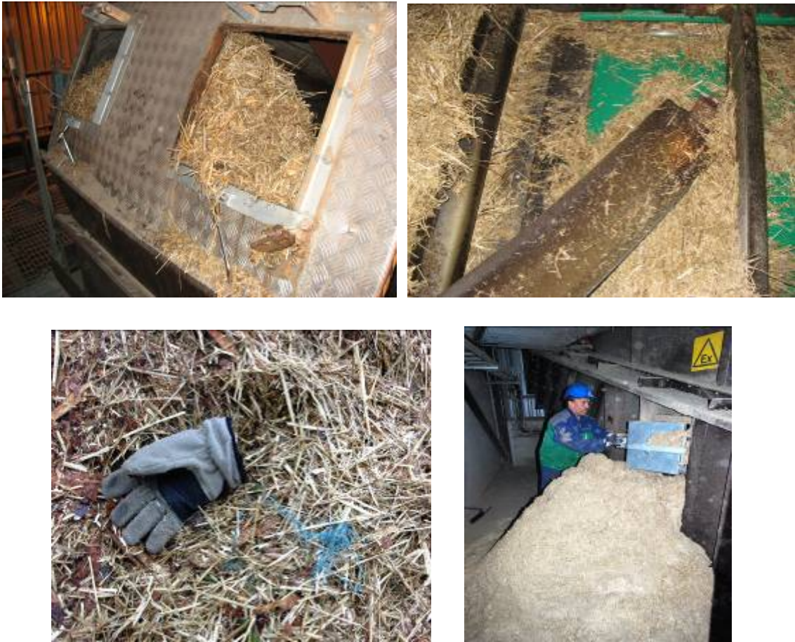
Kuva 49. Liian kosteiden helpipaalien murskaus aiheuttaa suuria ongelmia polttoaineen käsittelylinjassa. Pahimmillaan tukkeentumiset saattavat rikkoa kuljettimia (kuvat: Janne Kärki).
