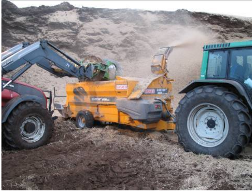
Kuva 16. Maatalouden paalisilppuri, joka tekee hyväksyttävän lyhyttä silppua eivätkä paalinarut ole liian suuri ongelma (kuva: Teuvo Paappanen).
