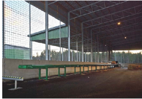
Kuva 61. Ruokohelpipaalien tanskalainen Reka-murskain ja noin 50 m pitkä paalien syöttölinja (kuvat: Samuli Rinne).
