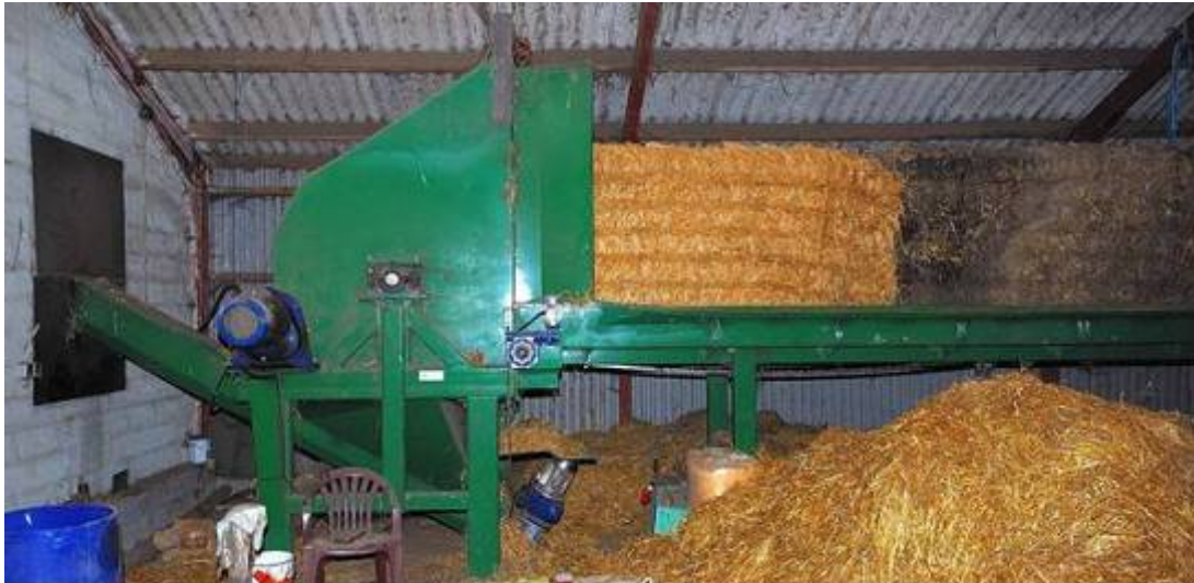
Kuva 19. Rekan hidaskäyntinen silppuri Tanskassa (kuva: Samuli Rinne).
