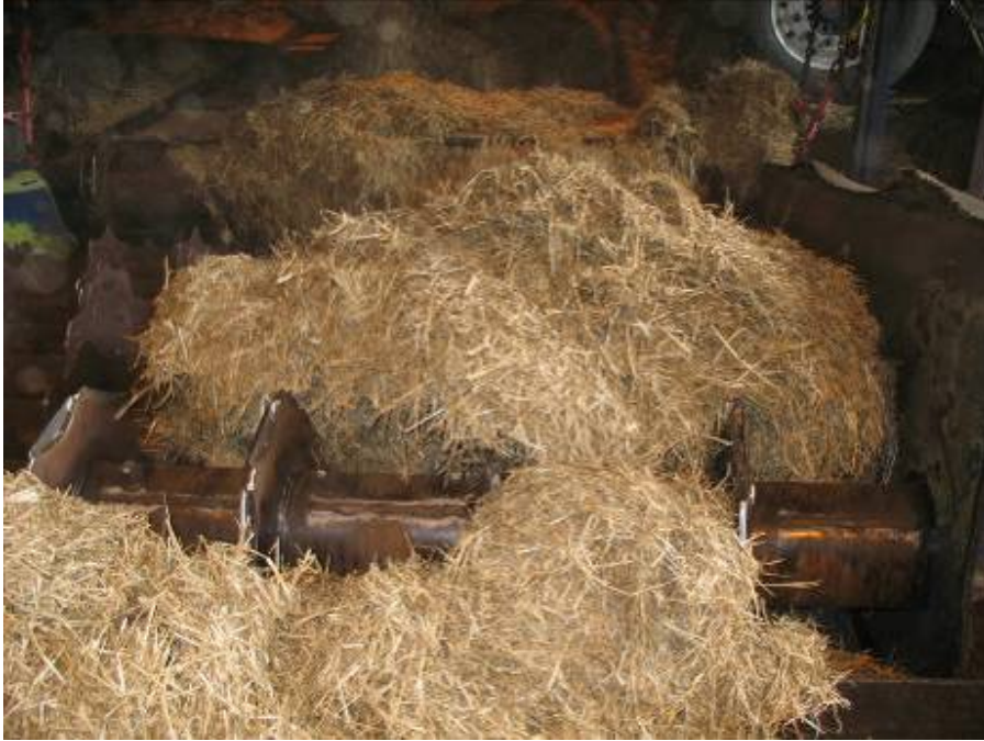
Kuva 50. Helpimatto vastaanoton erittäin harvalla kiekkoseulalla (kuva: Teuvo Paappanen).
