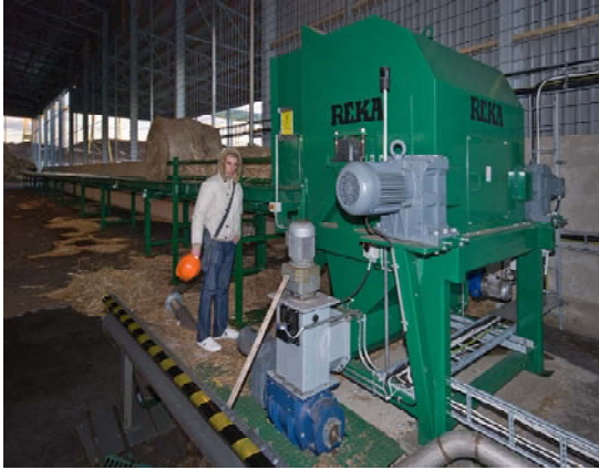
Kuva 61. Ruokohelpipaalien tanskalainen Reka-murskain ja noin 50 m pitkä paalien syöttölinja (kuvat: Samuli Rinne).
