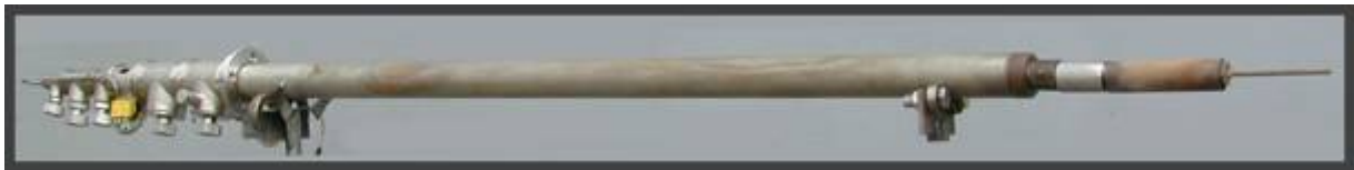
Kuva 52. VTT:n kehittämä ilma- ja vesijäähdytteinen kerrostumasondi (kuva: VTT).
