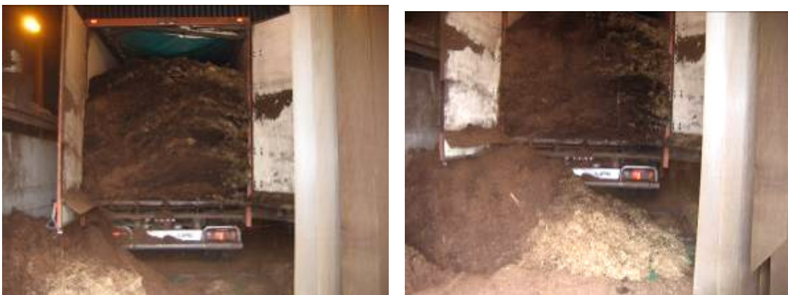
Kuva 31. Kaksi esimerkkiä ruokohelven kerroksista rekassa, kun seostus on tehty auman rintauksessa (Rinta-menetelmä) (kuvat: Risto Impola).
