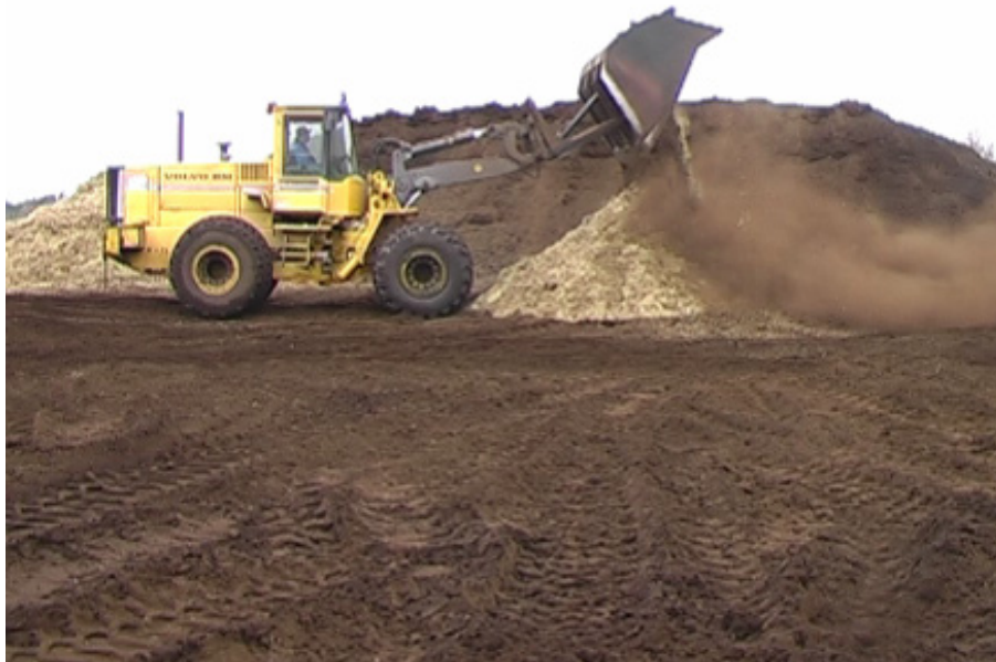
Kuva 27. Helven seostusta kasassa (kuva: Teuvo Paappanen).
