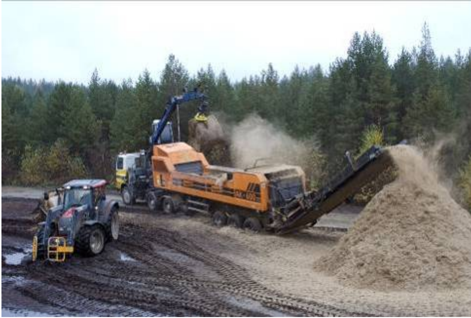
Kuva 17. Doppstadt-vasaramurskain, jonka tekemä silppu on erittäin lyhyttä. Murskain vaatii kantavat tiet, joten sen liikkuvuus turvetuotantoalueella on rajoitettu (kuva: Samuli Rinne).
