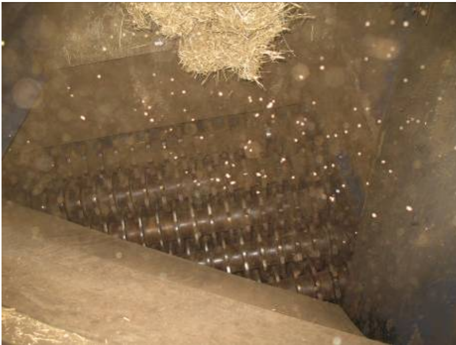
Kuva 51. Turvevastaanoton tiheä kiekkoseula (kuva: Teuvo Paappanen).
