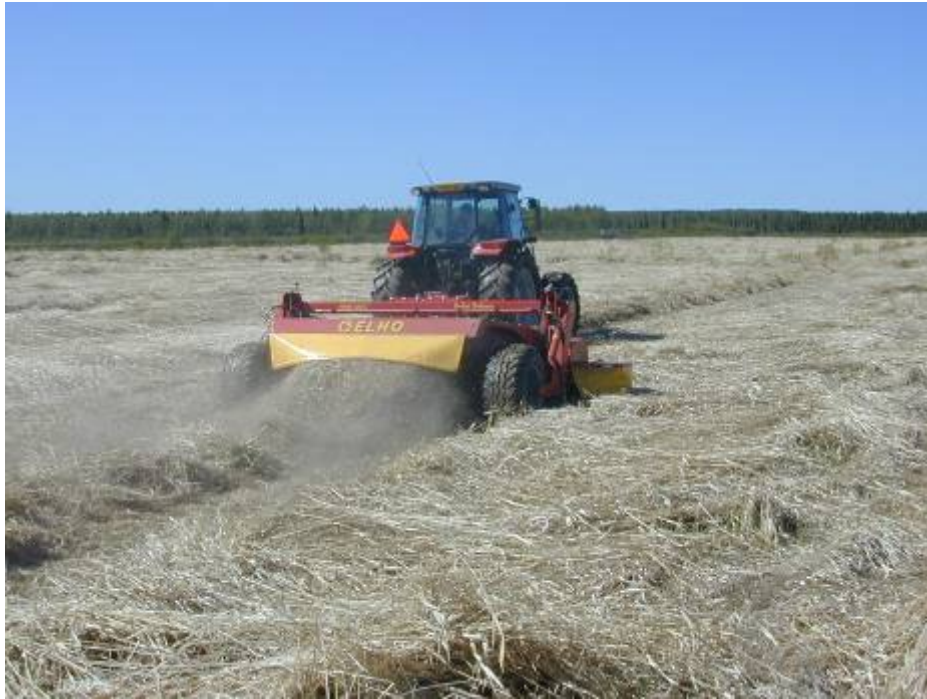
Kuva 2. Oikein säädetyllä niittomurskaimella päästään pieniin korjuutappioihin (kuva: Timo Lötjönen).
