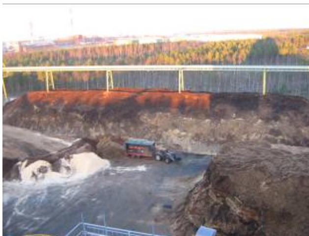
Kuva 59. Kokkolan voimalaitoksen polttoainekentälle varastoituja biopolttoaineaumoja (kuva: Risto Impola).
