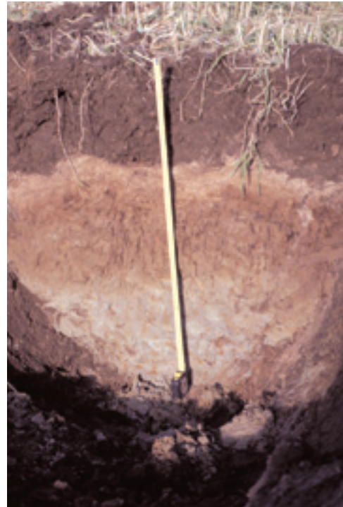
Kuva 19. Sotkamo 02, Tervapuro 2. Maassa on vaaleanruskea E-horisontti ja sen alla tummempi B-horisontti, joka ei kuitenkaan täytä spodic-horisontin vaatimuksia. Kuva: Päivi Nykänen-Kurki.
