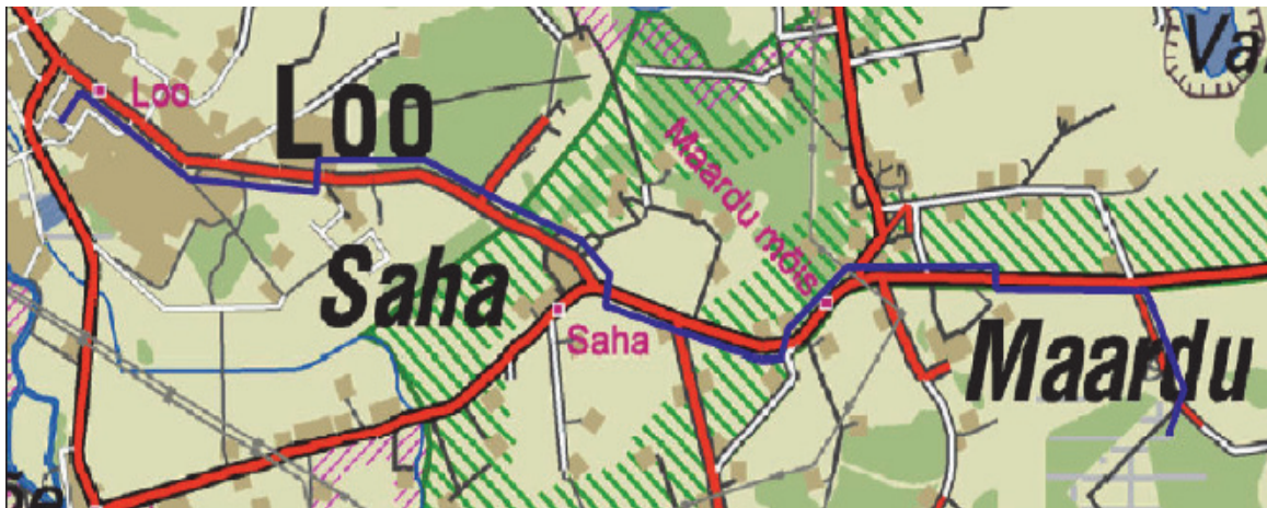
Joonis 2. Kavandatav gaasijuhe (märgitud siniselt) Maardu külas asuva biogaasijaama ning Loo asulas asuva soojuse ja elektri koostootmisjaama vahel (Loo Biogaasijaam ..., 2011)
