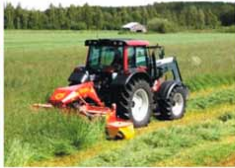
Kuva 55. Niittomurskaimia voidaan kytkeä olosuhteisiin sopivalla tavalla traktorin etu- ja takanostolaitteisiin. Kääntyvä etunostolaite parantaa niittoyhdistelmän työsaavutusta (Kuva: Valtra Oy Ab)
