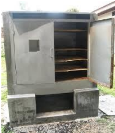
Gambar 2.3. Chamber pengasap (sumber: “rancang bangun instrumen dehidrator untuk pengasapan dan pengeringan hasil-hasil perikanan” Tjipto Leksono, Bustari Hasan dan Zulkarnaini)
